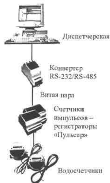
Рис. 2. Связь с диспетчерской через витую пару
