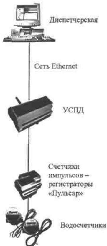
Рис. 6. Связь с диспетчерской через УСПД и по сети Ethernet
