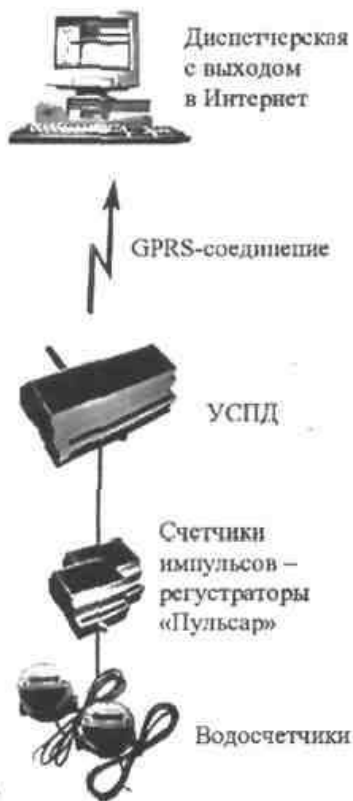
Рис. 5. Связь с диспетчерской с помощью УСПД и GSM-модема
