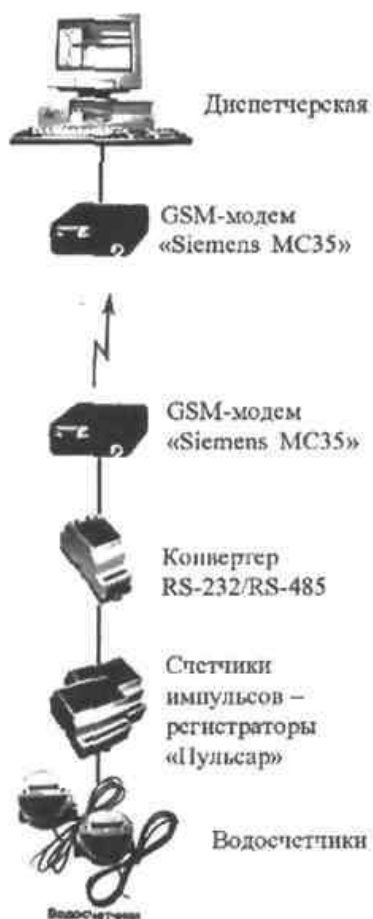
Рис. 3. Связь с диспетчерской с помощью GSM-модема
